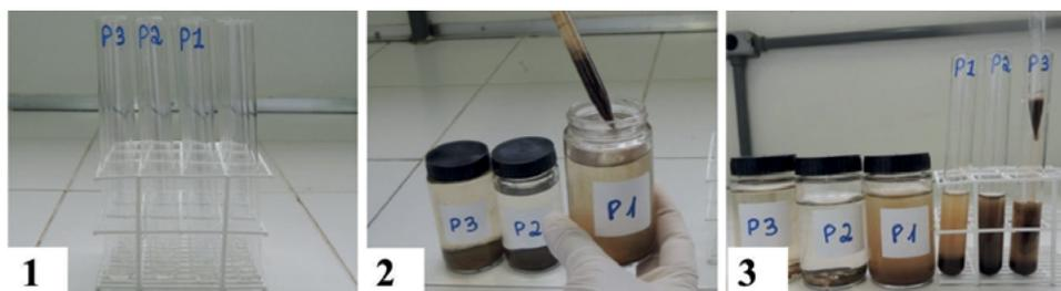
**Figura 5.** Procedimiento de tratamiento de muestras con ácido sulfúrico. (1) Adición de ácido sulfúrico en los tubos de ensayo (2) Muestras en vaso de precipitado que contiene fragmentos de porcelana y agua por encima de la altura del sedimento, para su posterior ebullición. (3) Hervido de muestras en la campana extractora. Adaptado de Lobo et al. (2016b).
